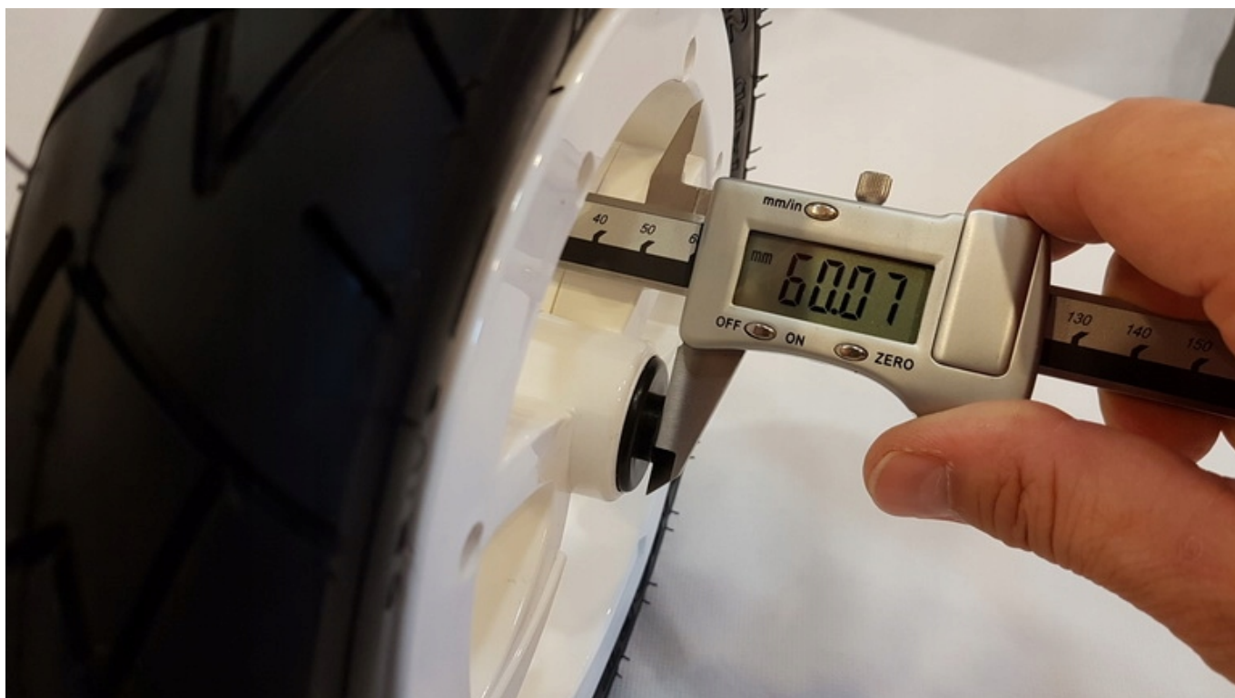
Szerokość piasty z zamontowanymi tulejkami:
